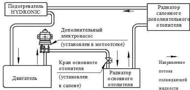
Рис. 20.14 Схема подключения подогревателя к системе охлаждения двигателя
