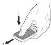
Рис.20.20 Замена батареек в пультах дистанционного управления
